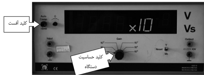
شکل ۲: میکروولت متر و کلیدهای اساسی آن
