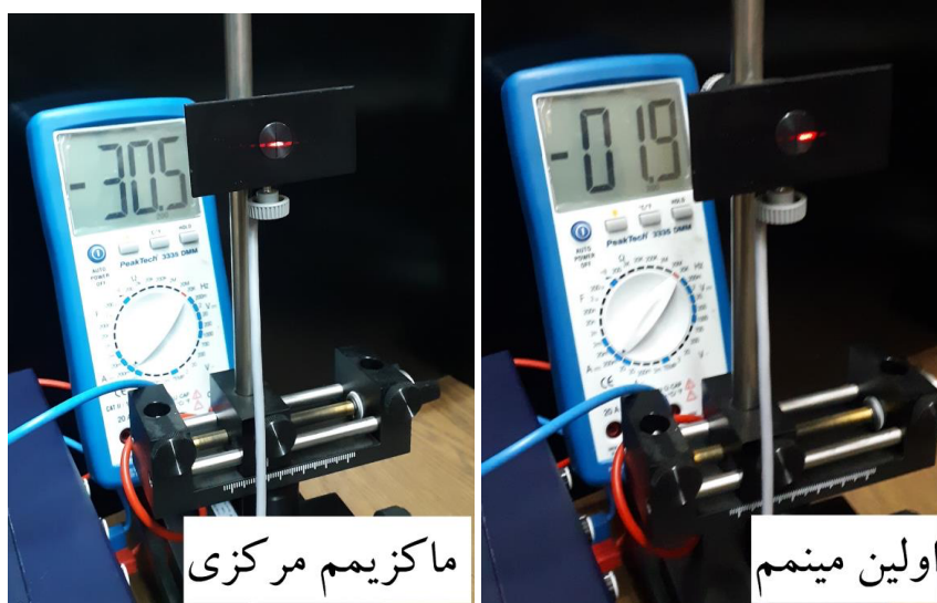
شکل ۷: محاسبه شدت نور با استفاده از فوتوسل
