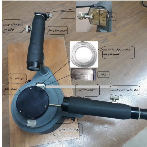
شکل ۱: قطعات دستگاه طیف سنج
