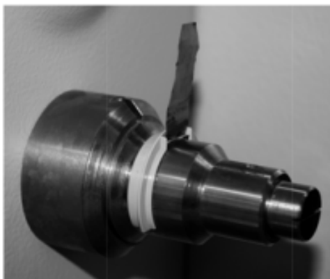
شکل ۸: ورقه زیرکونیوم در مسیر پرتوی اشعه ایکس
