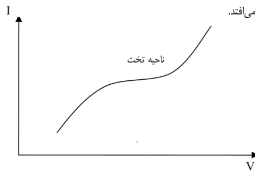
شکل ۳: شماتیکی از نحوه کار شمارنده و آشکارساز گایگر
