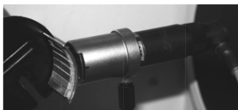
شکل ۹: ضخامت‌های مختلف آلومینیوم در مسیر پرتو اشعه ایکس و در مقابل آشکارساز گایگر
