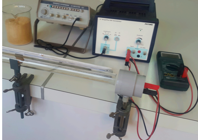
شکل ۳: آزمایش تشکیل امواج ایستاده در لوله کنت
